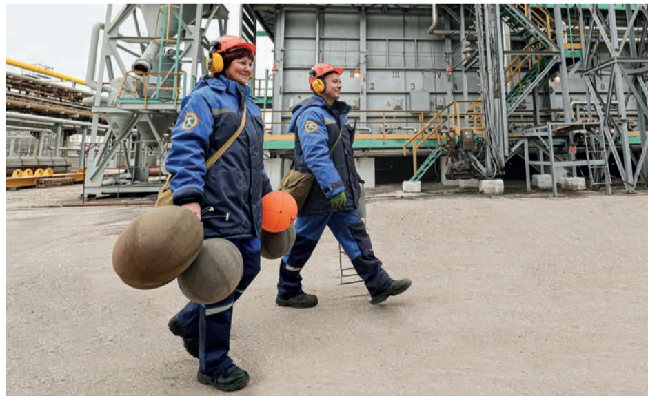
Санитарная лаборатория исследует качество воздуха в рабочих зонах. В такие резиновые камеры лаборанты отбирают пробы технологических газов
